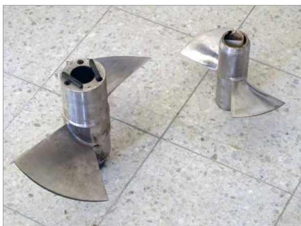
Technická novinka, Vírová turbína, již našla využití i v mikrozdrojích MVE
