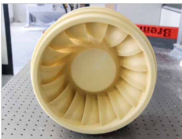
Model oběžného kola z vytavitelné hmoty, zhotovený 3D tiskem
