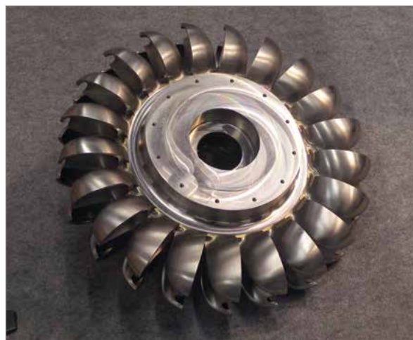
Peltonovy kola pracují na vyšších spádech
